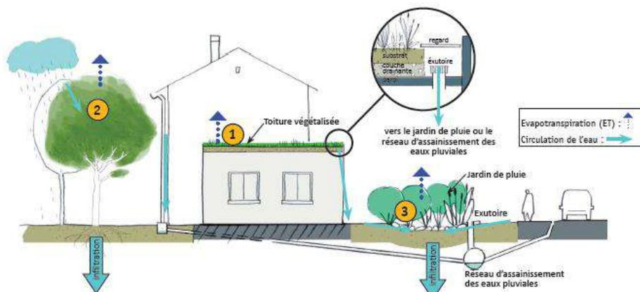
1. La toiture végétalisée stocke une partie de la pluie et, par rapport à un toit en pente, ralentit la vitesse de ruissellement.
