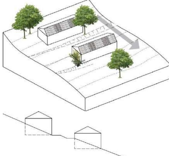
Un niveau semi enterré ou un soubassement permet de limiter les mouvements de terres et les terrassements dommageables pour le paysage (talus et plates-formes) et préserver ainsi le profil du terrain naturel.
